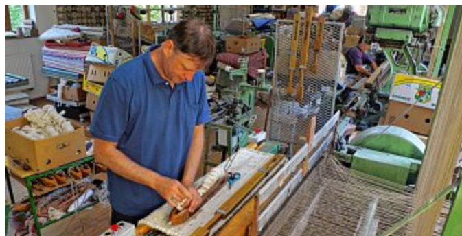
Mit einem großen Holzschiffchen schießt der Wollfaden dabei durch den Webstuhl.
